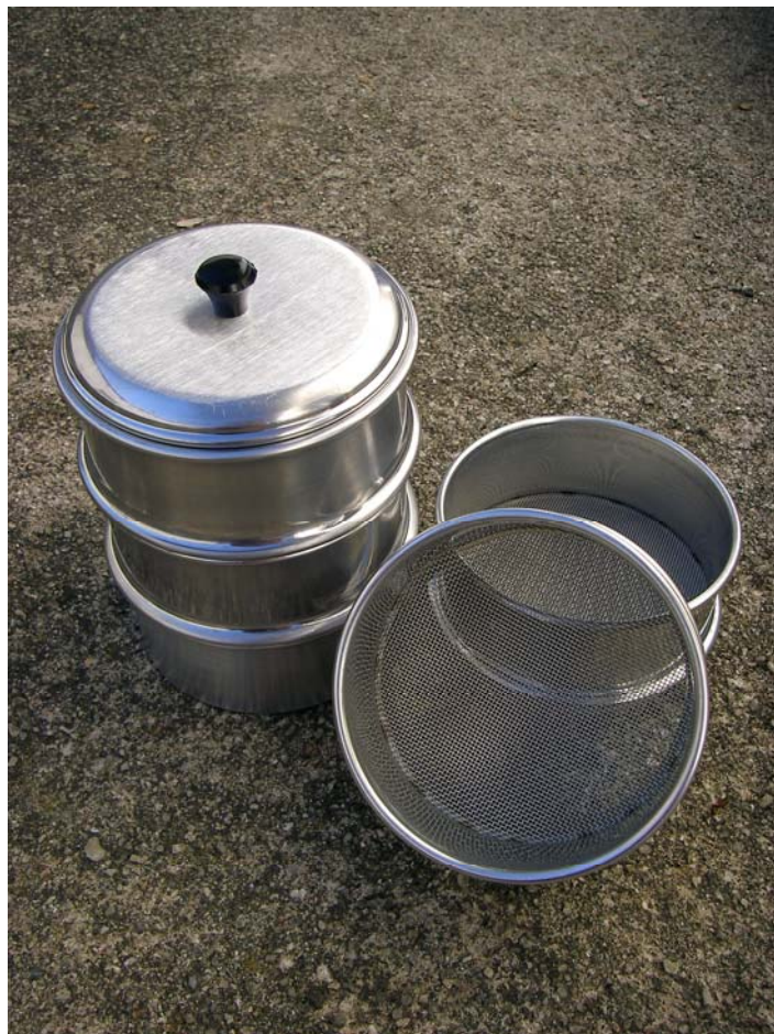
Figura 3: Crivos para determinação da granulometria do solo.
