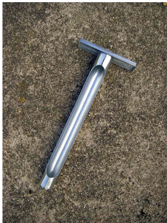
Figura 2: Material utilizado na análise do solo (A - Manual para identificação da cor do solo; B – Ferramenta para retirar amostras de solo)
