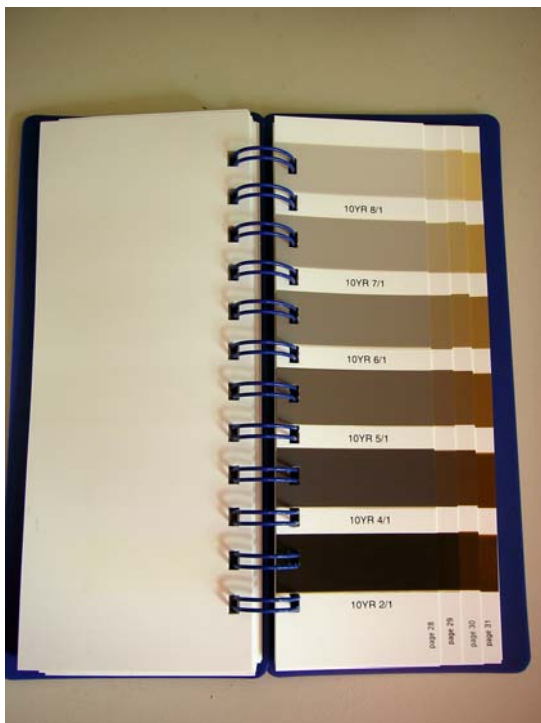
Figura 2: Material utilizado na análise do solo (A - Manual para identificação da cor do solo; B – Ferramenta para retirar amostras de solo)
